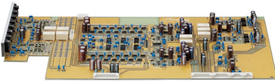
Zbalansowana płyta sterowania głośnością AAVA
